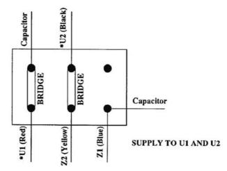
\* LIVE AND NEUTRAL SUPPLY CAN BE CONNECTED EITHER WAY ROUND TO U1 AND U2. EARTH TERMINAL ON TERMINAL BOX CASING
